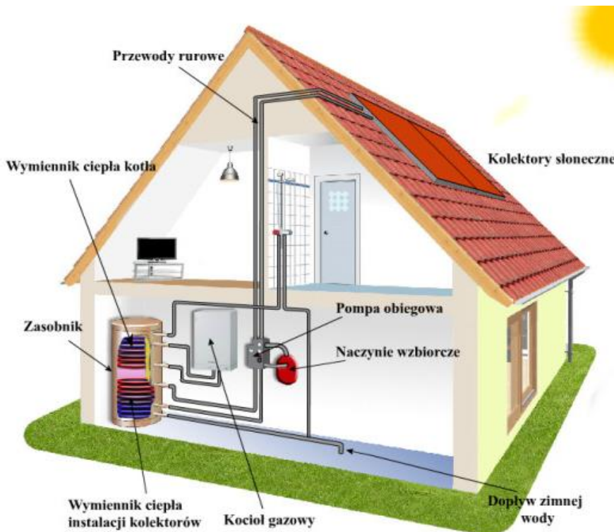
Ryc. 13. Schemat instalacji kolektorów słonecznych w domu jednorodzinnym
